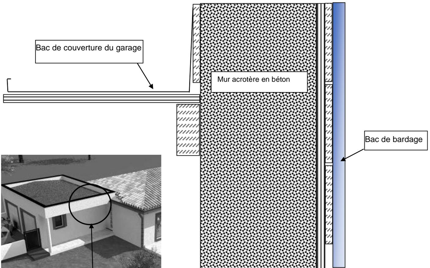
Le point d'étanchéité à étudier se situe entre la couverture en zinc du garage et le bardage en zinc au-dessus du passage de la porte d'entrée.
