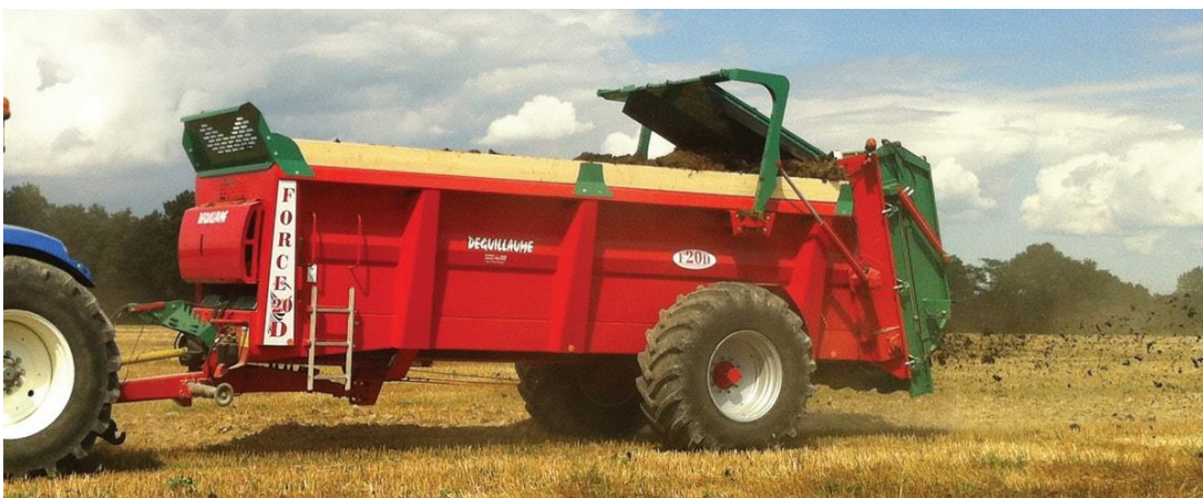
Figure 2 – Exemple d'épandeur à caisse étroite "FORCE 20 D" de volume utile 20 m 3 .
