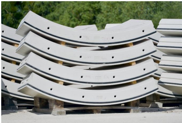
Fig. 6 Voussoirs préfabriqués et entreposés avant livraison
