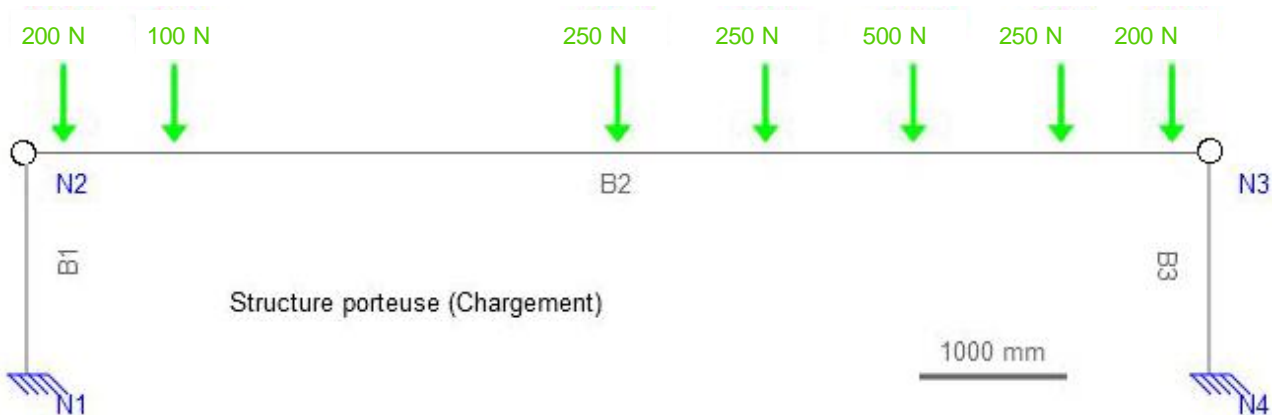
Figure 1 : modélisation de la structure porteuse
