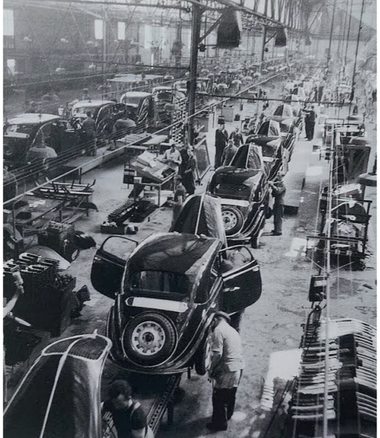
C. François Kollar (1904-1979), Chaîne de montage des automobiles Peugeot : montage des pare-chocs , usine Sochaux, 1931-1932, photographie.
