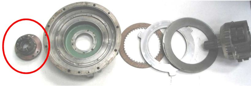
Boîtier d'entrée ouvert avec le « Support avant », le ressort Belleville, le train épicycloïdal...
