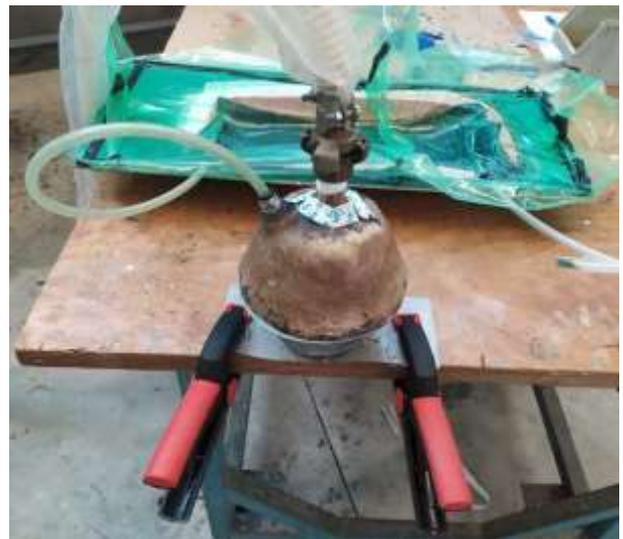
Montage d'infusion avec piège à résine
