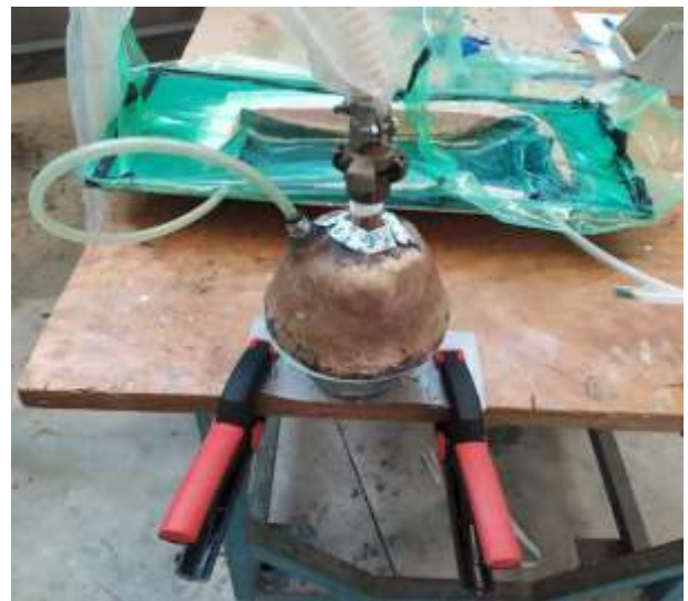
Montage d'infusion avec piège à résine
