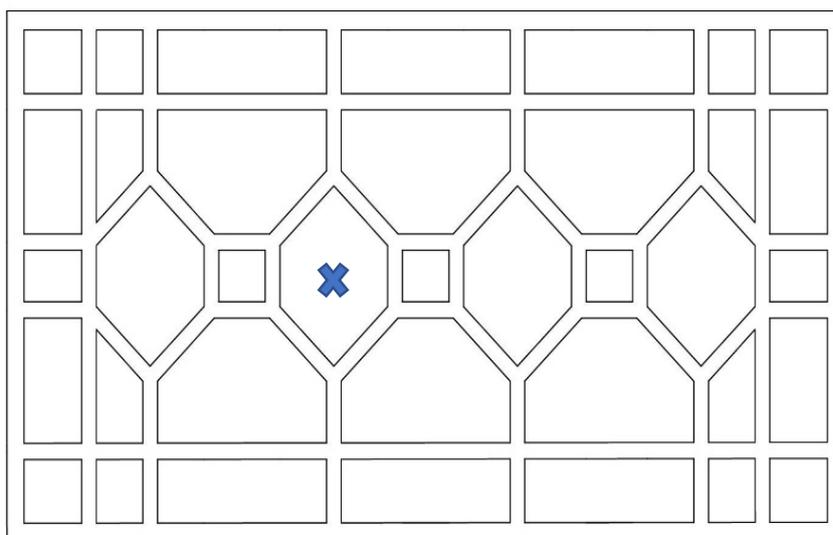
Mesures CDV : 218 x 390 mm – Plomb de sertissage : 6/5 – Plomb d'entourage : 8/5
