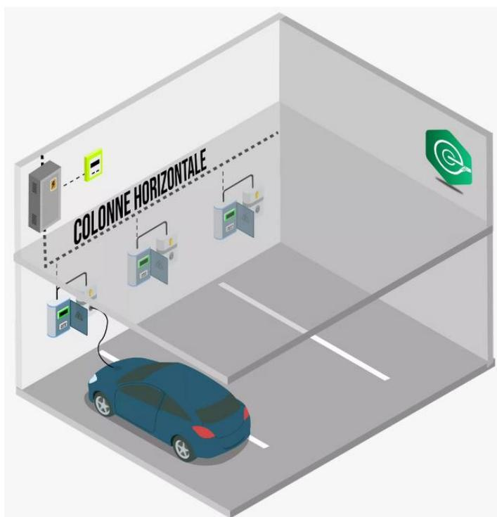
Cette configuration s'appuie sur l'installation par ENEDIS d'une colonne électrique horizontale en parking en complément de la colonne montante. Des dérivations individuelles (avec installation d'un compteur) sont réalisées pour chaque utilisateur en faisant la demande.
