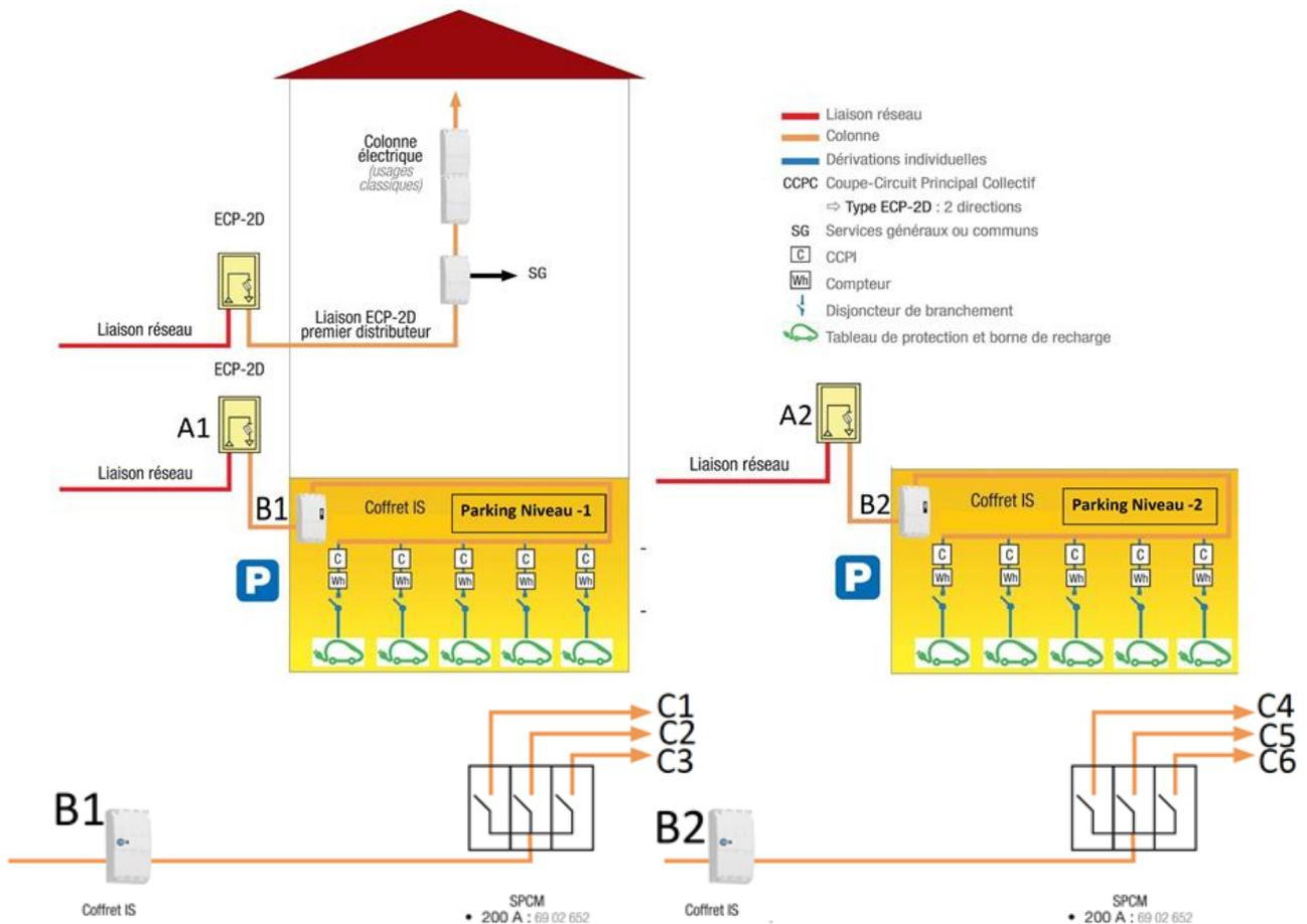
Pour une question de sécurité, l'ensemble de la colonne horizontale se situe au niveau -1 ce qui facilite l'intervention des pompiers pour la coupure en cas d'incendie ou d'anomalie de celle-ci. Ces amorces issues du poste raccordent chacune un interrupteur sectionneur Pompier 400 Ampères.
