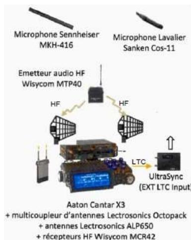
Le microphone Sennheiser MKH 416, dont les spécifications techniques sont fournies en annexe 8, est utilisé pour capter une voix humaine assez éloignée sur des scènes d'extérieur.
