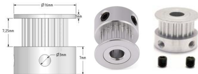
Figure 13 : Caractéristiques poulie crantée GT2
