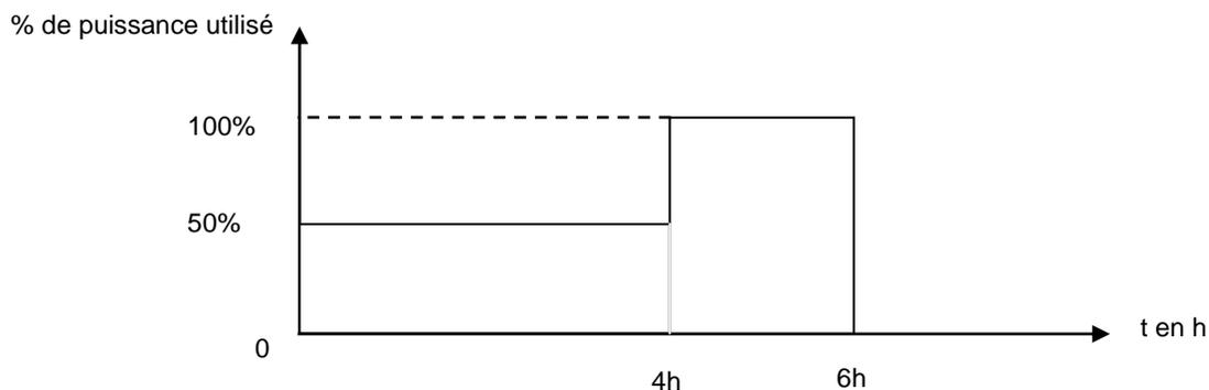
Figure 2 : Cycle de puissance des batteries
