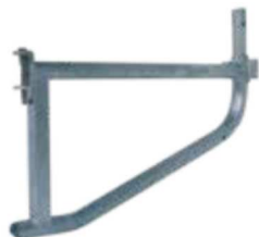
Console C08-EMD800 (800 mm) avec manchon 2 planchers 360 mm ou plancher 730 mm
