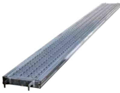
Plancher acier R14 AC CS 3000 x 300 avec crochets soudés Longueur : 3000 mm / Largeur : 300 mm
