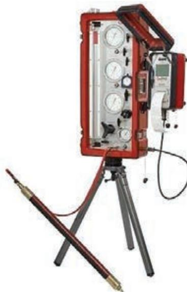
*Figure 12 : Matériel d'essai pressiométrique*
