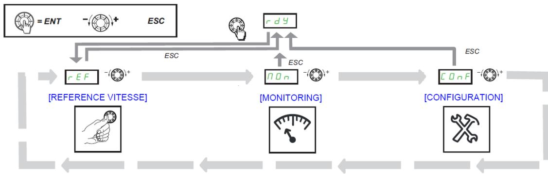
Les codes des menus sont suivis d'un tiret pour les distinguer des codes de paramètres. Exemple: [SIMPLY START]5 , n -, paramètre E C C .
