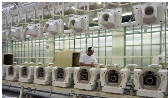
Bancs de coulage en moules plâtre.
