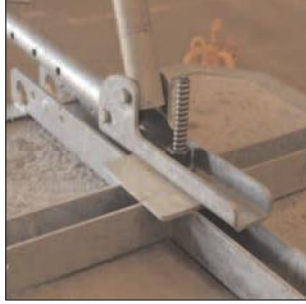
Chape de fixation d'étais Pour la fixation des étais sans crochet, orientable selon l'inclinaison de l'étais.
