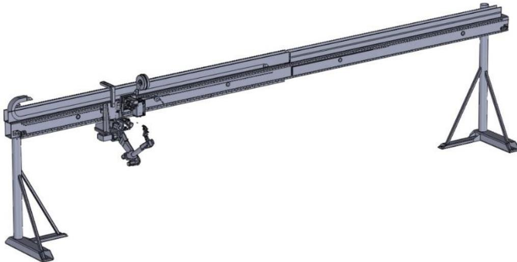
Afin de vérifier la viabilité de cette solution une première étude est faite avec les hypothèses suivantes : la poutre est considérée comme encastree à chaque extrémité et le poids du robot est ramené dans le plan de symétrie de la poutre
