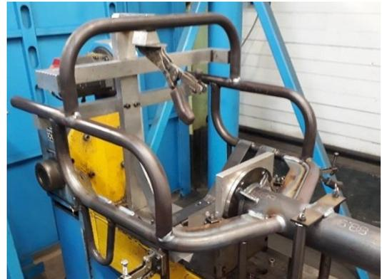
Etape 2 : soudage robotisé du châssis
