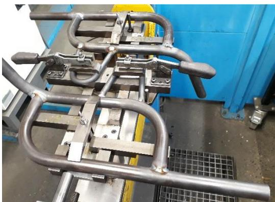
Étape 1 : préparation des pièces pour le soudage robotisé
