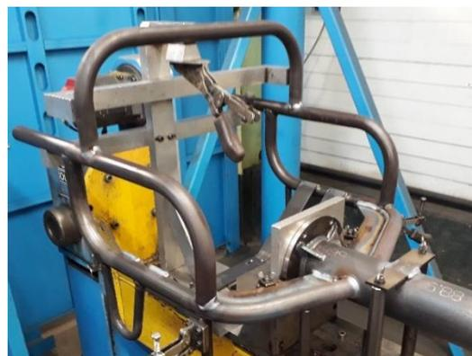
Étape 2 : soudage robotisé du châssis
