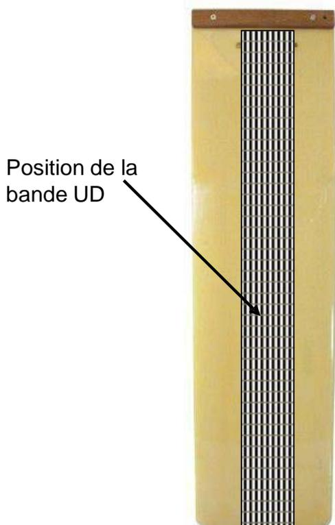
La dérive est une pièce mobile située dans l'axe de la coque et, qui abaissée, sert à s'opposer au déplacement latéral du bateau sous l'action du vent.
