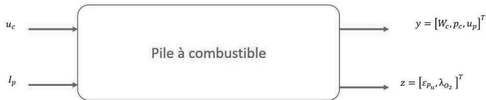
Figure 7 : Représentation des entrées/sorties de la pile
