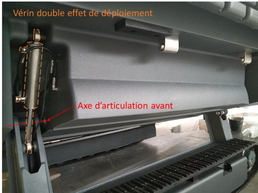
Figure 3 – Système de déploiement
