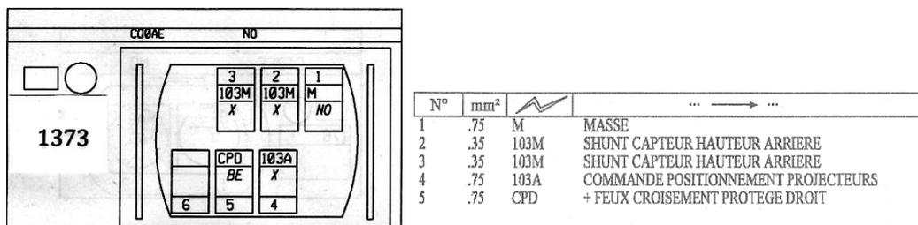
15/ Lors du choc, trois fils se sont débranchés de la borne de raccordement 1373 du capteur de hauteur avant. Vous devez les remettre à leur place respective en vous aidant des documents techniques électricité, page 14/17 et 15/17.
