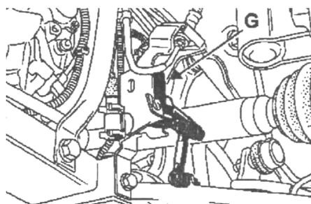
**Enregistre la hauteur du train avant, gère le réglage des projecteurs en fonction des variations de l'assiette, en fonction des accélérations, freinage et charge du véhicule.**
