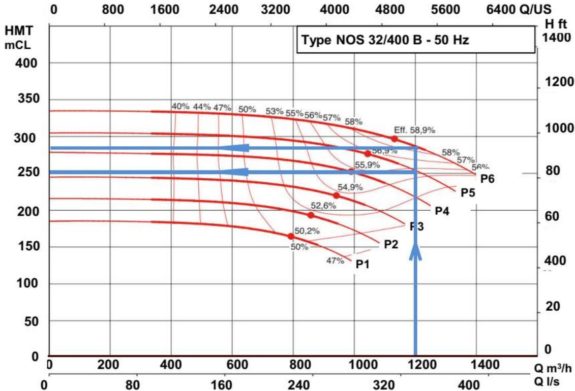
**Choisir** (sur le graphique) parmi les 6 pompes P1 à P6, la pompe la plus adaptée aux conditions de la production (HMT= 250 mCL, débit = 1200 m<sup>3</sup>/h) en supposant que le point de fonctionnement doit être le plus proche du rendement effectif (symbolisé par un point sur le tracé de la HMT). Les courbes d'iso rendement sont tracées sur le graphique.
