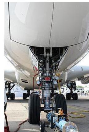
Pour sortir le train nous devons commander le vérin de manœuvre du train ainsi que 2 vérins de verrouillage. Il est demandé par l'avionneur que le train se déploie en 5 secondes. Le vérin de déploiement est un vérin de marque Quiri, dont la référence est la suivante :
