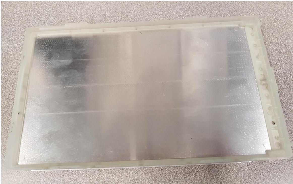
La pièce finale (cellule) est surmoulée en PP GF20 (Polypropylène avec 20 % de fibre). Les cellules sont des éléments accumulateurs de batterie. Ces pièces sont assemblées entre elles puis montées dans un carter (enveloppe batterie) qui sera rempli par un liquide électrolytique. Sous l'effet du déplacement des ions entre la cathode ou l'anode et selon leur sens de circulation, la batterie se charge ou se décharge (Production d'électricité et alimentation de l'appareil branché).
