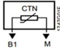
Figure 1 : schéma électrique du capteur de température
