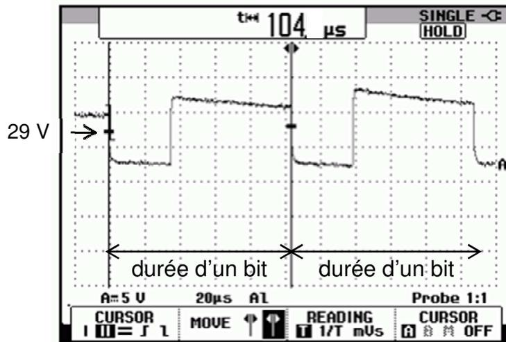
Figure 6 : oscillogramme de la tension en bout de ligne
