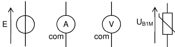
Figure 2 : symboles électriques des appareils
