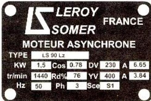
Sur la plaque signalétique, la tension 400V (celle du réseau) correspond au couplage étoile (Y).
