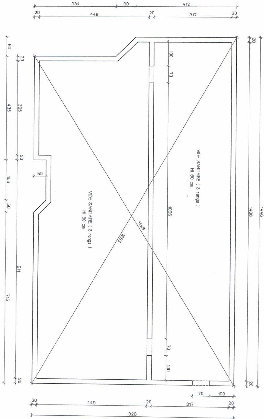
PLAN DU REZ DE CHAUSSÉE (sans échelle – cotation en cm)
