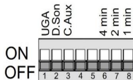
Dipswitch de paramétrage de l'UGA
