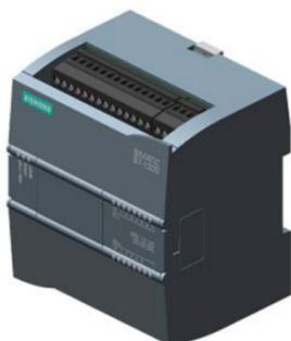
SIMATIC S7-1200, CPU 1212C, CPU compacte CC/CC/CC, I/O intégrées: 8 DI 24V CC; 6 sorties TOR 24V CC; 2 AI 0-10V CC, alimentation: CC 20,4-28,8V CC, mémoire de programme / de données 75 Ko
