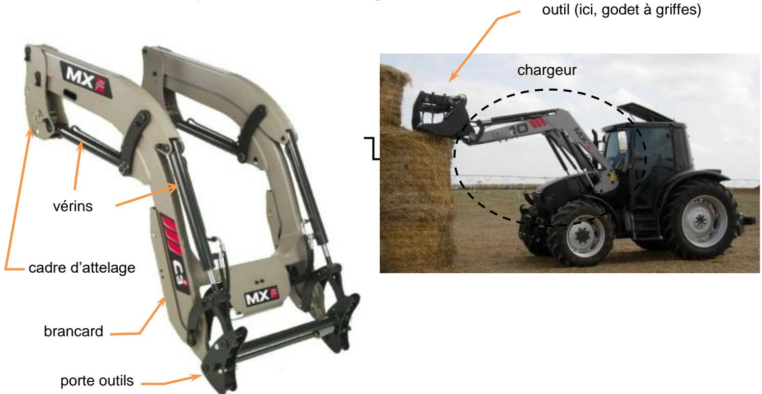
Principalement destinés aux agriculteurs, les chargeurs sont des équipements qui facilitent les tâches de manutention. Ils s'installent à l'avant du tracteur et permettent le relevage de différents outils (pinces à balle, godet désileur, godet à griffes...).
