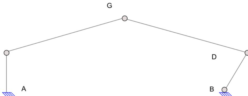
En remplaçant l'encastrement par une articulation, (on enlève une action mécanique de contact) la structure devient un mécanisme, elle était donc bien isostatique avec un encastrement.
