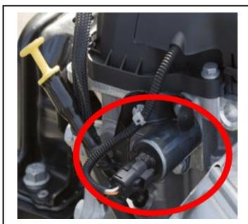
L'électrovanne du déphaseur **d'échappement** est placée à gauche du collecteur d'échappement.
