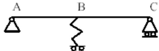
Dans le cadre de ce projet, la rigidité de l'appui central est prise égale à  $k = 2100 kN/m$
