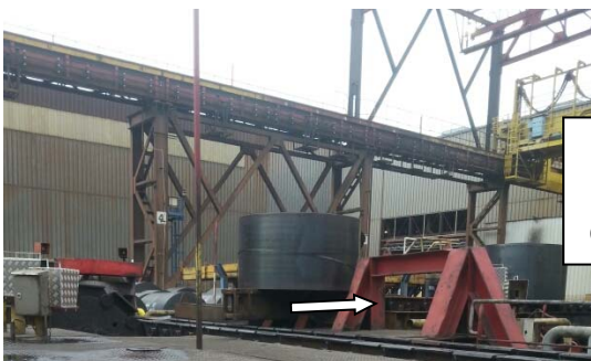
Étape 6 : Évacuation de la bobine au finissage
