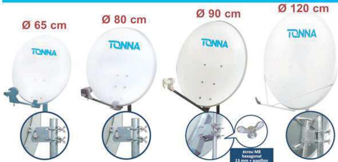
Antennes en aluminium destinées à la réception individuelle (diamètres 65 et 80 cm) ou collective (diamètres 90 et 120 cm) en numérique. Les antennes 80 et 90 cm peuvent être équipées de brides bi-tête 6° pour recevoir simultanément ASTRA et HOT BIRD.
