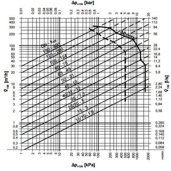
100 kPa = 1 bar = 10 mCE 1 m<sup>3</sup>/h = 0,278 kg/s d'eau à 20 °C 7) Relever le diamètre nominal de la vanne 3 voies à partir de l'abaque.
