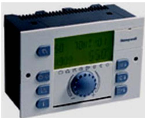
Régulateur : détermine la température de départ idéale fonction de la température extérieure grâce à la loi de chauffe
