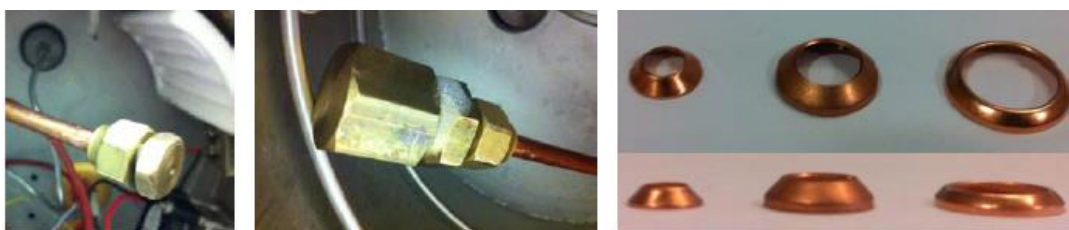
Joints Flare 3/8 en test Joints Flare 1/2 en test 3 tailles de joints
