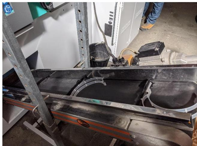
Optimisation de la production : équipement de la presse avec tapis d'évacuation et automatisation du remplissage en granulés de polypropylène
