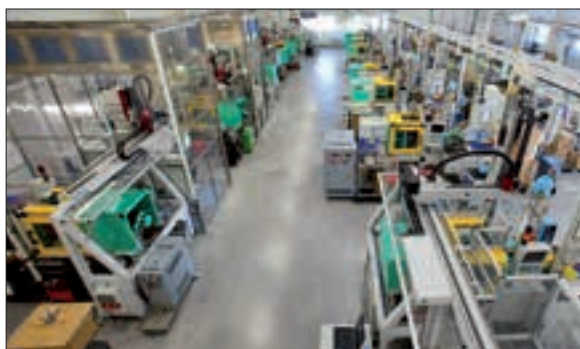
Très automatisé, l'atelier d'injection comporte une vingtaine de presses de dernière génération. Source : David Cresbon
