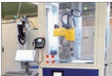
Solution clés en main, Multipilot assure un contrôle total de l'usinage, l'autocorrection des commandes numériques ainsi que des étapes de tri et de palettisation. Source : Cetim-Ctdec
