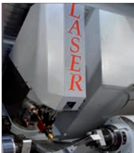
Cette solution combine cinq technologies d'usinage (fraisage 5 axes, cladding, polissage robotisé, contrôle et marquage laser). Elle remplace ainsi plusieurs équipements nécessaires pour réparer ou ajouter des fonctions à une pièce complexe comme les pales de turbine. Source : Delcam
