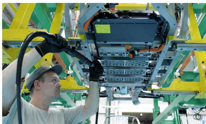
La batterie est placée le plus bas possible dans le châssis, sous le siège du conducteur. Elle est constituée d'éléments Lithium - ion, sa tension nominale est de 52.5V, sa capacité est de 116 A/h.
