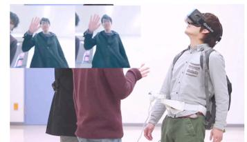
**BIRDLY** : Ce projet venu de Suisse est un nouveau type de simulateur de vol. Grâce à un masque de réalité virtuelle et une table sur laquelle il faut s'allonger, l'utilisateur a l'impression de devenir un oiseau. Les mouvements de ses bras et jambes agissent directement sur la manière de « voler », et la table dispose d'un ventilateur diffusant de l'air en fonction de la vitesse.
