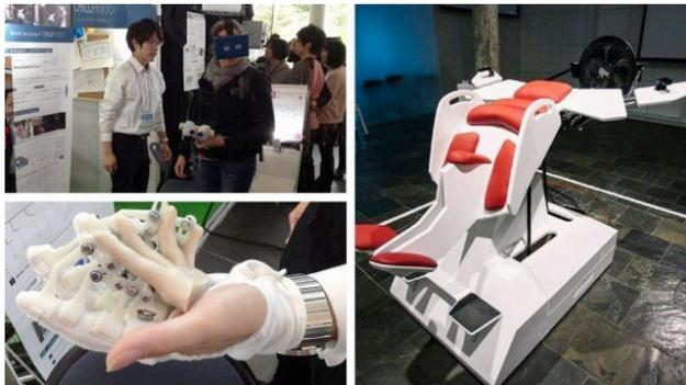
**Birdly** - Ce projet venu de Suisse est un nouveau type de **simulateur de vol**. Grâce à un masque de réalité virtuelle et une table sur laquelle il faut s'allonger, l'utilisateur a l'impression de devenir un oiseau. Les mouvements de ses bras et jambes agissent directement sur la manière de « voler », et la table dispose d'un ventilateur diffusant de l'air en fonction de la vitesse.
