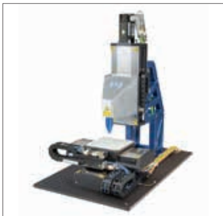
Cet ensemble XYZ industriel rapide, flexible et ultra-précis doté de moteurs linéaires est dédié aux procédés d'usinage ou de marquage laser. Source : PI
