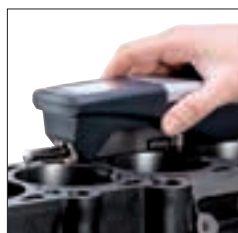
Cet appareil portable assure le contrôle des surfaces en atelier avec précision et rapidité.
