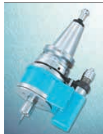
On peut transformer facilement et économiquement une fraiseuse en une machine d'usinage par ultrasons grâce à l'installation d'une broche ultrasonique.
