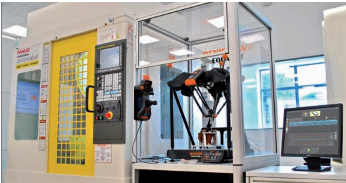
Les solutions métrologiques temps réel sont indispensables pour assurer la précision et la qualité de la fabrication. Une démarche illustrée par le comparateur 3D Equator de Renishaw couplé avec une machine Robodrill de Fanuc . Source : Renishaw
