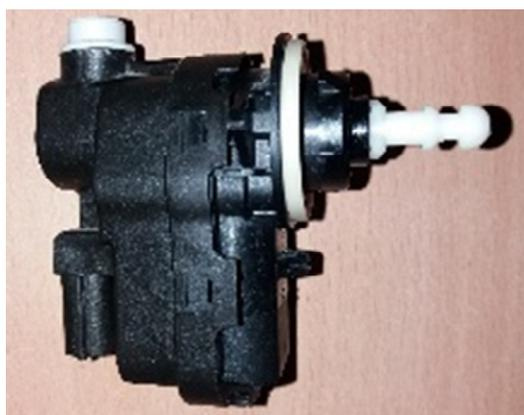
Ils sont en liaison avec les blocs optique « PURE LED VISION » par l'intermédiaire d'une biellette.
