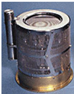
Figure 8 – Photographie d'un propulseur ionique développé par les laboratoires de recherche Hughes
