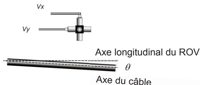
Figure 17 : alignement du ROV sur l'axe du câble
