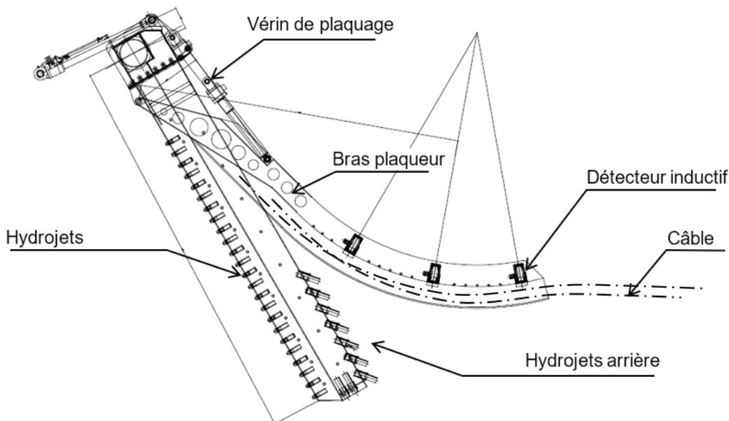
Figure 18 : système presseur et hydrojets
