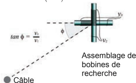
Figure 14 : détermination de l'angle relatif en utilisant deux bobines
