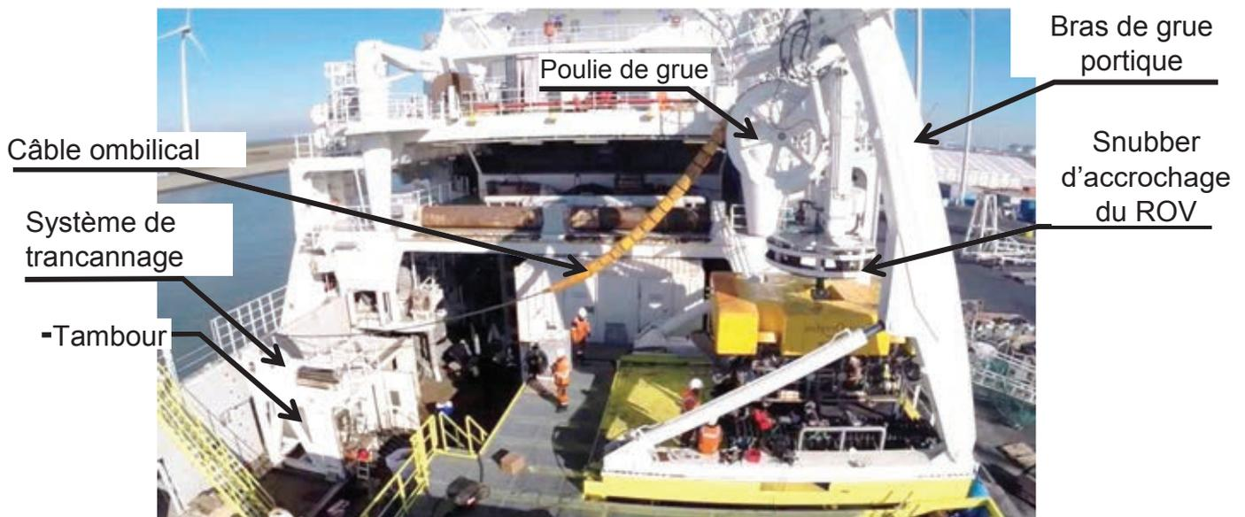
Figure 5 : photo de l'implantation de la grue et du tambour d'enroulement sur le pont du navire
