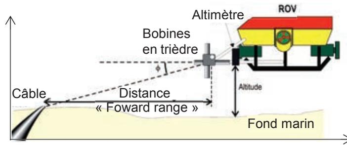
Figure 15 : recherche du câble à longue distance
