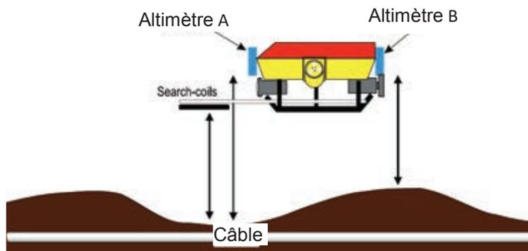
Figure 11 : ensemble de détection du câble
