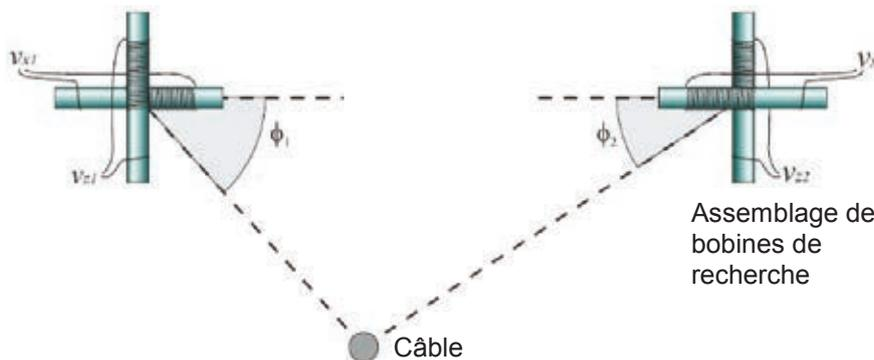
Figure 16 : centrage du ROV le long du câble
