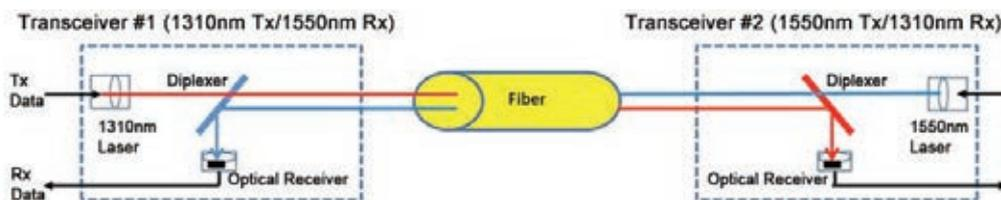
Figure 23 : architecture du système d'émission réception
