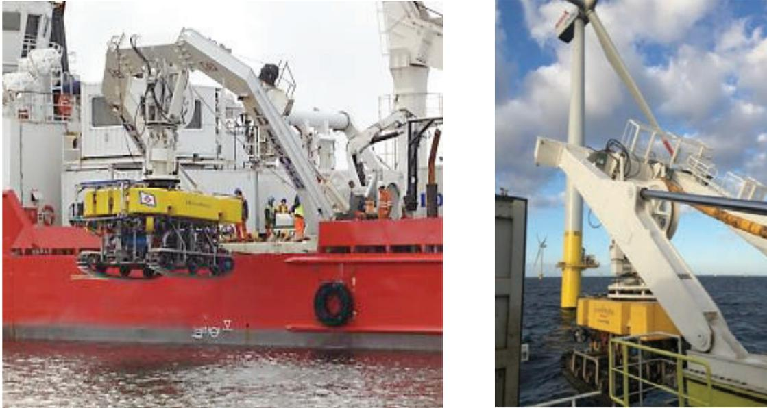
Figure 4 : ROV suspendu à la grue portique
