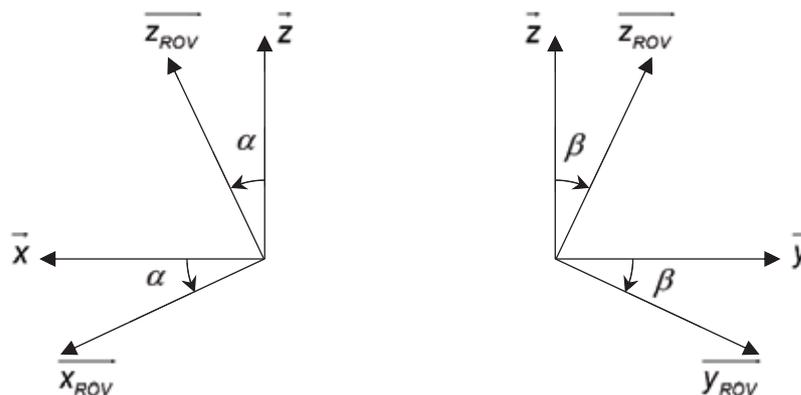
On souhaite que ces deux angles soient inférieurs à  $3^\circ$  pour des raisons de sécurité au moment de la sortie de l'eau du ROV.
