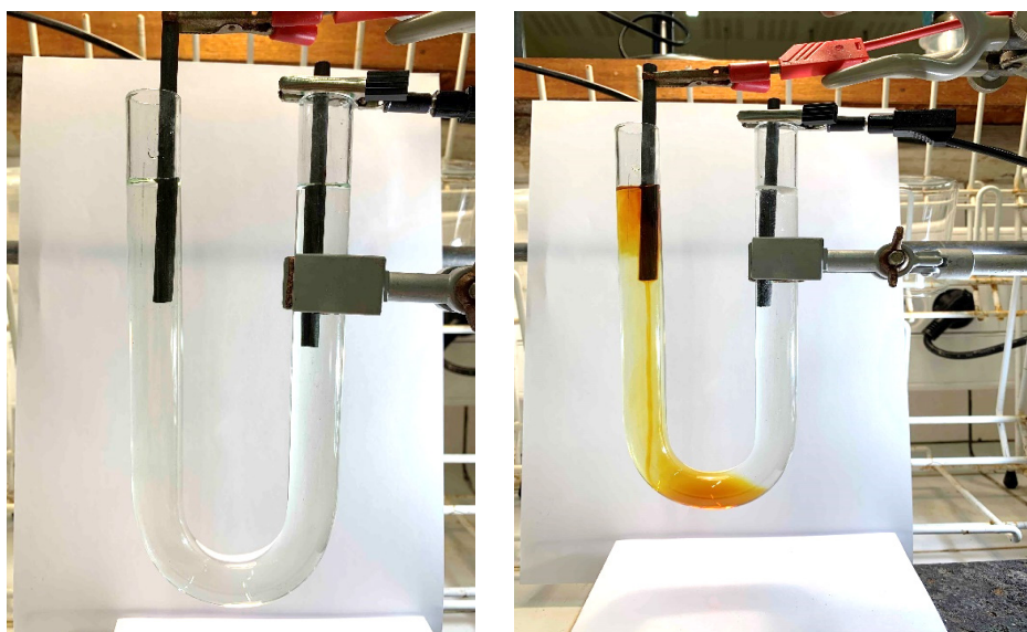
À gauche, aspect du système avant électrolyse ; à droite, aspect du système après quelques minutes d'électrolyse.
